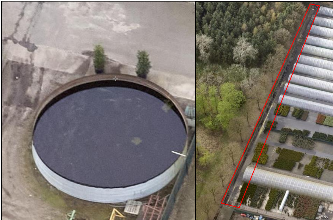
Figuur 24: Regenwater opvang silo en sloot omkaderd voor de opvang van regenwater
